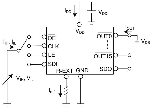
■ TEST CIRCUIT FOR SWITCHING ELECTRICAL CHARACTERISTICS
